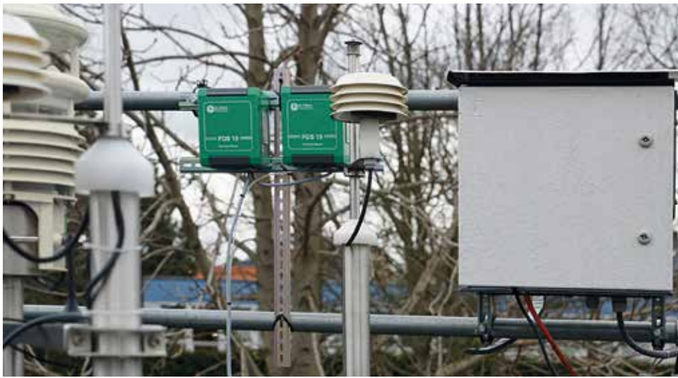
Feinstaubsensor der Dr. Födisch Umweltmeßtechnik AG zur Überwachung der Luftqualität
